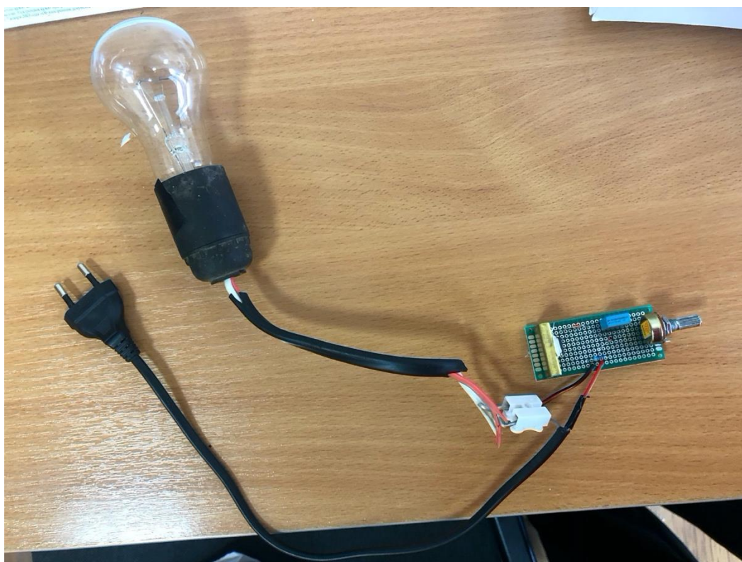
3.3 Сурет - Қыздыру шамының қуатын реттеуге арналған симисторлық қуат реттегіші
