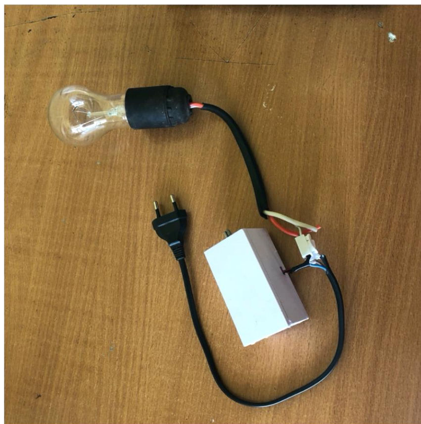
3.5 Сурет – Тасымалдауға ыңғайлы және қауіпсіздік үшін ПВХ-мен қапталған қуат реттегіші
