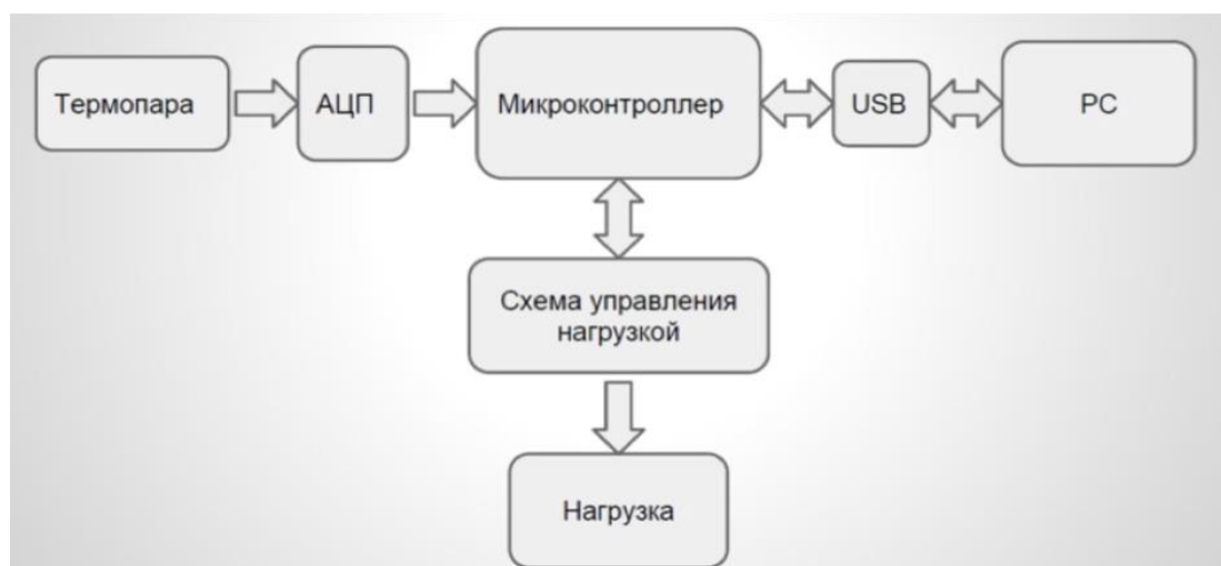
2.4 Сурет – Құрылғының функционалдық сұлбасы
